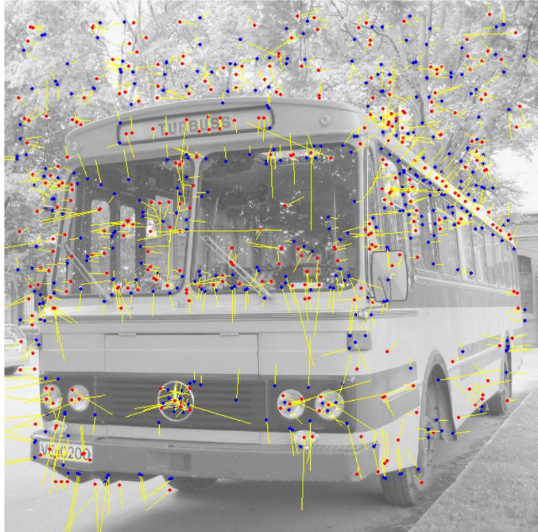
Abbildung 4.5: SURF-Keypoints mit Rotation für die Abbildung 4.1b
